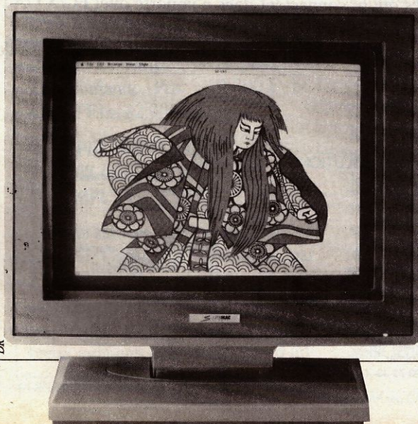
Moniteur couleur ou noir et blanc, interfacé avec la carte Spectrum pour Macintosh II. Image de Pat Coleman créée avec Illustrator.
